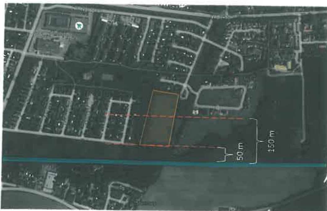
Figur 1. Illustration av det rekommenderade skyddsavståndet 50 m från närmsta befintliga spårkant, samt RIKTSAMS riskhanteringsavstånd på 150 m.
